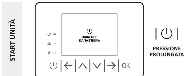
Una volta alimentata l'unità di recupero calore e attivato l'interruttore generale, avverrà l'accensione del display che mostrerà la schermata di "Unità OFF DA TASTIERA", ovvero macchina spenta da display. Da questa schermata, è necessario una pressione prolungata del tasto "ON/STAND-BY" per attivare l'unità e passare alla schermata principale.
