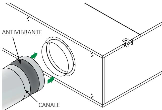
Fissaggio delle canalizzazioni d'aria su bocche CIRCOLARI di mandata e ripresa
