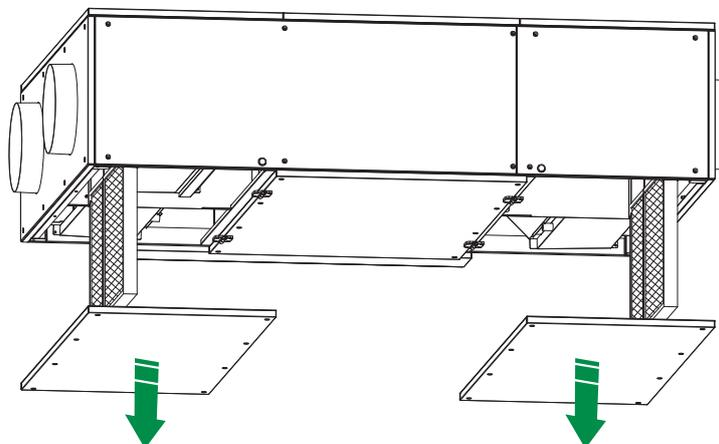
Per estrarre il recuperatore bisogna svitare le viti del pannello inferiore centrale, come mostrato nell'illustrazione sottostante.
